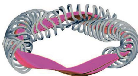
Fig. 13. – Nel disegno è mostrata la forma del plasma (in fucsia) e delle bobine magnetiche (in grigio) in uno stellarator. La camera di tipo toroidale è completamente avvolta da bobine magnetiche che generano il campo elicoidale necessario al confinamento. Fonte: https://www.euro-fusion.org/fusion/fusion-technology/types-of-fusion-machines/stellarators/
