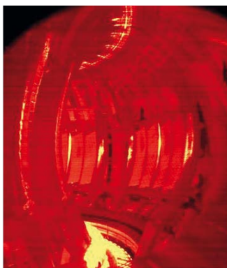
Fig. 18. – Immagine ai raggi infrarossi della camera da vuoto del JET con il plasma, dove risultano ben visibili le regioni con maggiore carico termico (in giallo), sia concentrate sul divertore (nella parte inferiore della camera) sia più localizzate (hot spots sulle pareti laterali). Fonte: http://www-fusion-magnetique.cea.fr/cea/jet/jet_irv.htm , ©CEA, 2009.
