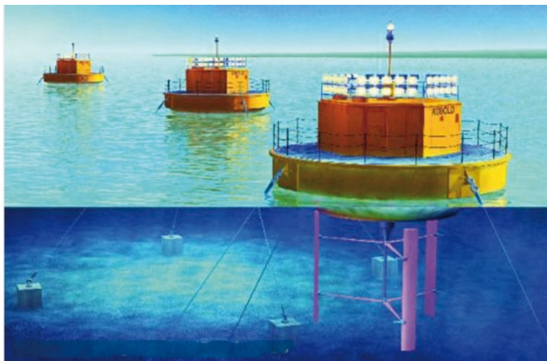
Fig. 14. – Illustrazione di un sistema con turbina Kobold ad asse verticale per lo sfruttamento delle correnti marine. © Copyright Image Factory/Quark n.26.
