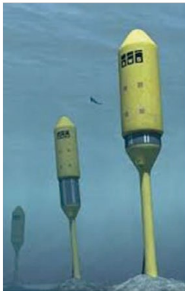
Fig. 10. – Illustrazione grafica del sistema AWS ( Archimedes Wave Swing ).
