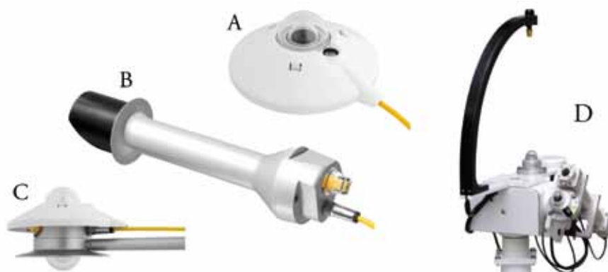
Fig. 11. – Sulla sinistra: immagini di alcuni solarimetri. Trattansi in particolare di un piranometro (A), un piroeliometro (B) un albedometro accoppiato ad un piranometro (C). Sulla destra (D): immagine di una stazione per la misura delle diverse componenti (globale, diretta, diffusa e riflessa) della radiazione solare. La trave di colore nero ha la funzione di ombreggiare uno dei due piranometri, il quale ha quindi la funzione di misurare la radiazione diffusa (fonte: www.kippzonen.com ).
